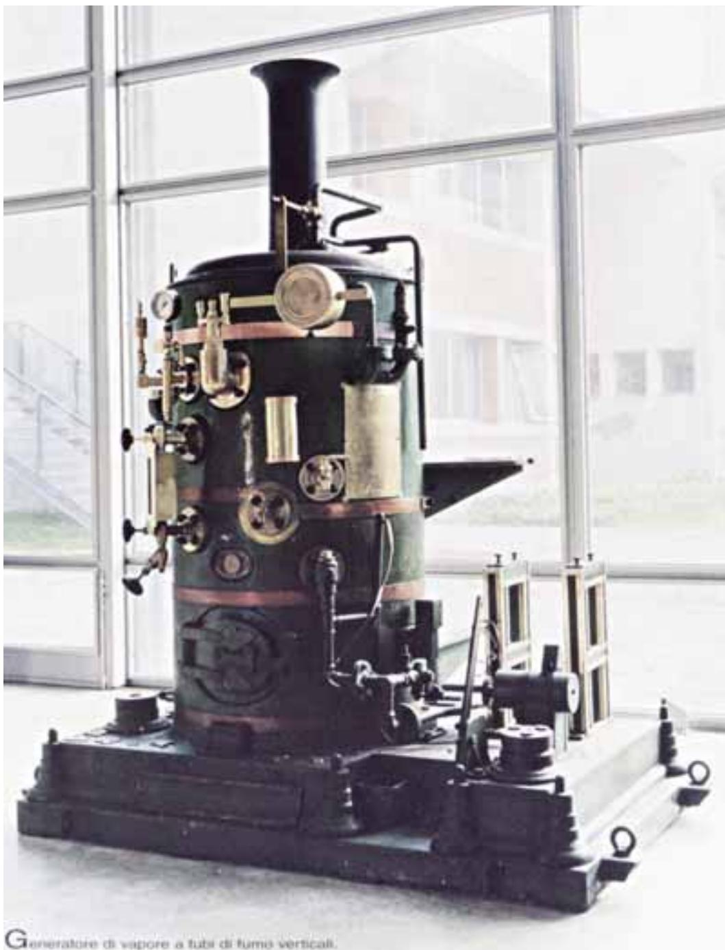
Generatore di vapore a tubi di fumo verticali.
