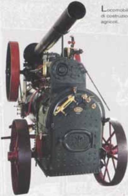
Locomobile Brown & Mack semovente con trasmissione a carena munita di regolatore watt.
